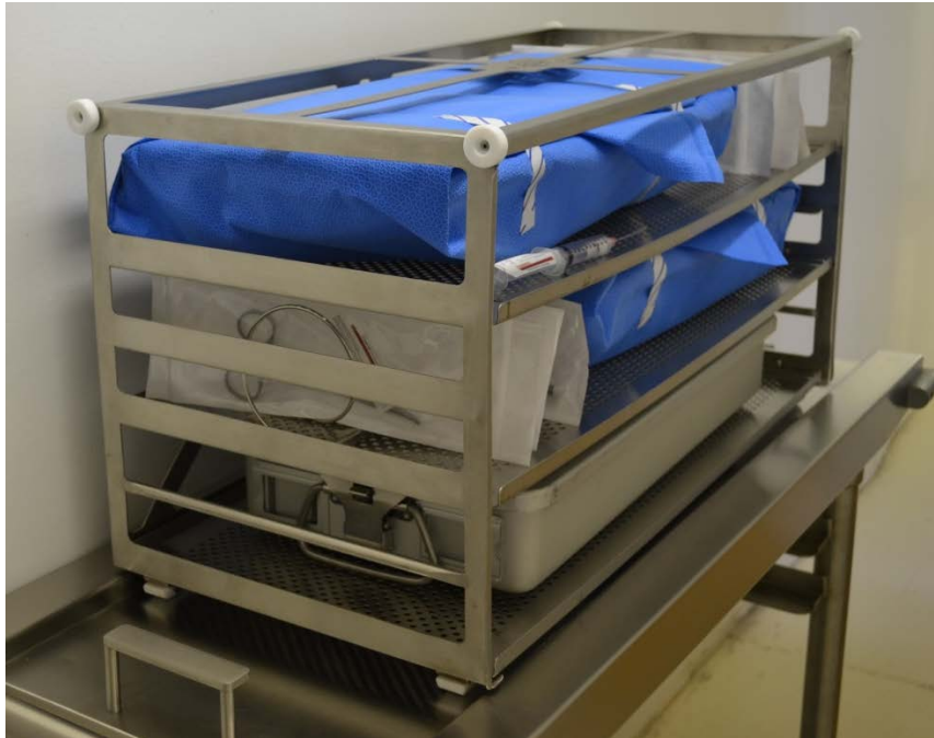
Figure 4. Charge de validation n° 3 : trois endoscopes flexibles à simples canaux avec d'autres dispositifs médicaux généraux
